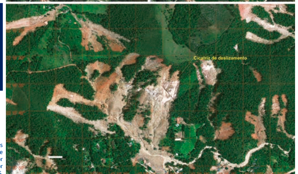
Cicatrices de los deslizamientos en Nova Friburgo obtenidas a partir de imágenes satelitales
